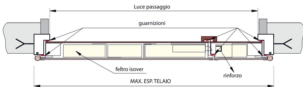
La porta corazzata mod. 51N è dotata di un telaio unico a cementare nel muro con robuste staffe. La struttura viene costruita su misura del vano esistente e permette di installare rivestimenti di differente spessore, fino a 26 mm, sia in legno che bachelite o alluminio.
