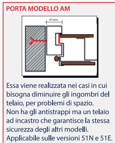
Essa viene realizzata nei casi in cui bisogna diminuire gli ingombri del telaio, per problemi di spazio. Non ha gli antistrappi ma un telaio ad incastro che garantisce la stessa sicurezza degli altri modelli. Applicabile sulle versioni 51N e 51E.
